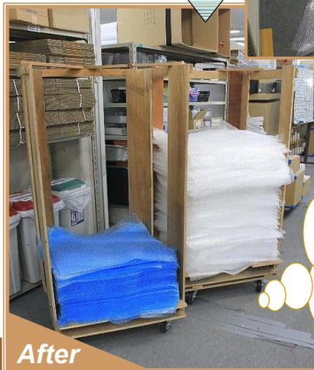
エアパッキンのサイズに合わせた木枠を作成!これでパッキンの出し入れも簡単!見た目もスッキリ♪しかも積んでいく部分に傾斜をつけ、ずれ落ちないようにしているという小技も効いています!
